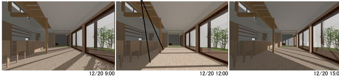
①12/20日射しが室内の奥までとどくことがわかる。暖房負荷を減らす日射しが入る開口部については、日射遮蔽性能が低く、内部の熱を逃がさない高断熱複層ガラスを採用する。
